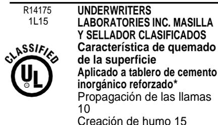
\*PROBADO Y APLICADO EN TRES CORDONES DE DIÁMETRO DE 3/4" EN CENTRO DE 8" CUBRIENDO 8.3% DEL ÁREA DE LA MUESTRA DE PRUEBA EXPUESTA
